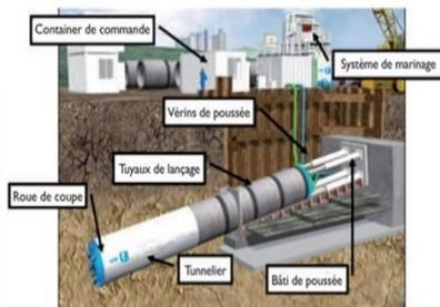
**Analyse des techniques constructives** pour mieux caractériser la faible profondeur en milieu argileux
