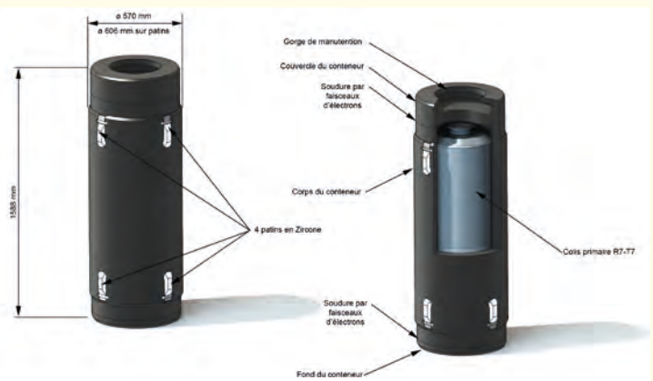
Figure 2 : schéma du surconteneur de déchets vitrifiés.
