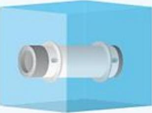
Immersion à 15 m : pour les colis de type B contenant plus de 100 000 A<sub>2</sub> : immersion jusqu'à 200 m. Critère : pas de rupture de l'enceinte de confinement
