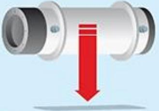
**1** Chute de 9 m sur une surface indéformable
