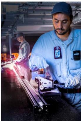
Contrôle visuel d'un crayon de combustible MOX. Atelier des assemblages combustible MOX. ©Orano, E. LARRAYADIEU
